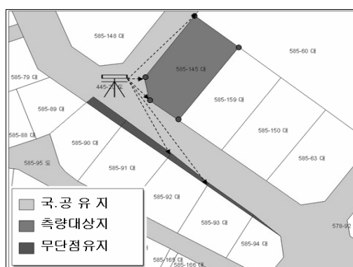
그림 2. 지적측량과 연계한 무단점유 확인 과정
